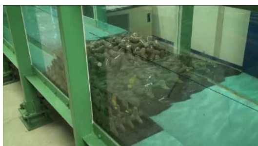
消波ブロックの消波効果を確認する実験の様子
