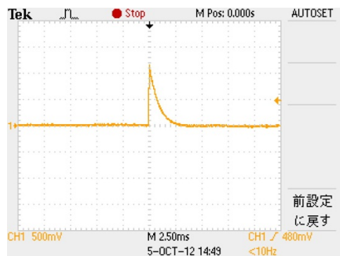
放射線検出回路からの出力波形 放射線源であるマンテルを PIN フォトダイオードに近付けた時に計測される波形。バックグラウンドに対して十分大きな波形が計測されている。
