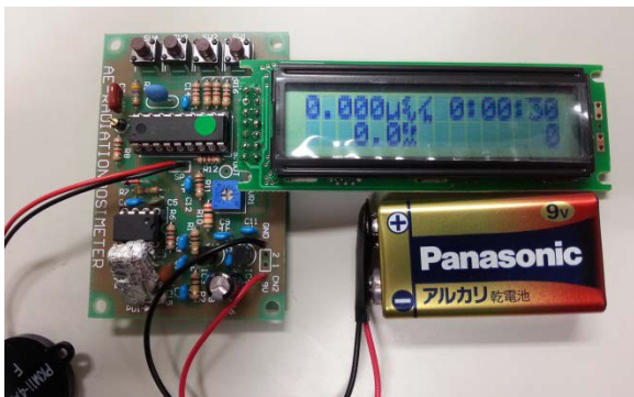
作製した簡易放射線量モニターキット PIN フォトダイオードを使用した簡易放射線量モニターキットの作製写真。 PIN フォトダイオードで検出した信号を増幅し、PIC マイコンにて計数している
