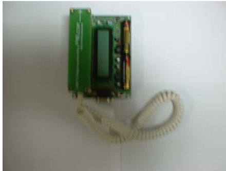
図1 組立てたガイガーミュラー係数管 動作試験中の組立てた組立てガイガー係数管
